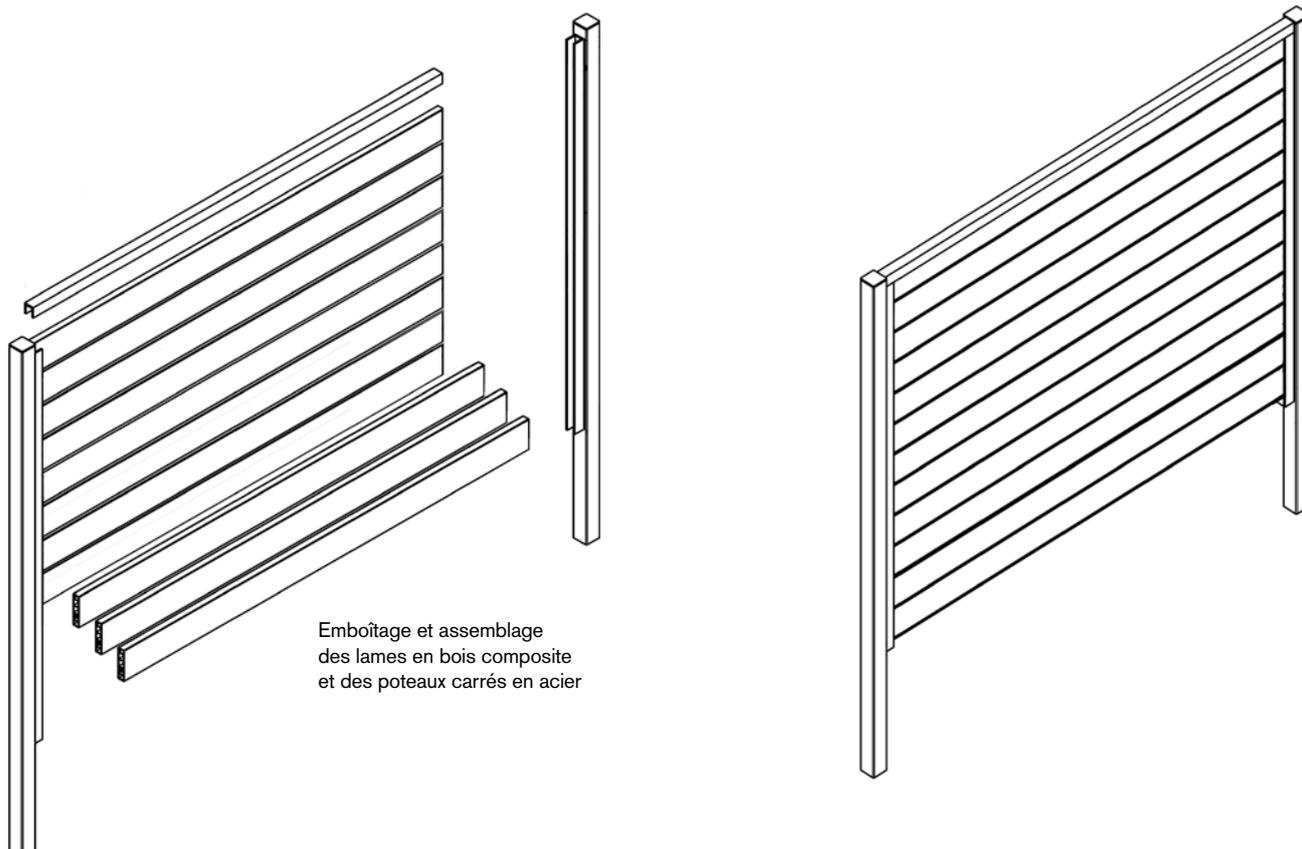
Emboîtement et assemblage des lames en bois composite et des poteaux carrés en acier
